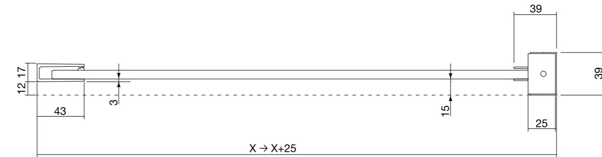
1 lato fisso con profilo ad incasso e sostegno a soffitto (art. VT1LINPA) - Sp. 8 mm
